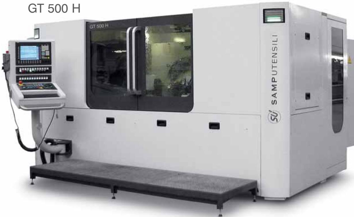
La rettifica GT 500 H è ideale sia per le attività di prototipazione che per la rettifica di lotti di ingranaggi medio-grandi. Dotato di asse aggiuntivo per spostamento utensile e di un elettromandrino sincronizzato con tavolo portapezzo, questa macchina è in grado di lavorare con due mole, una specifica per la sgrossatura e l'altra dedicata al processo di finitura.
