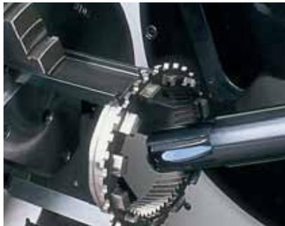
Rettifica di ingranaggio interno elicoidale
