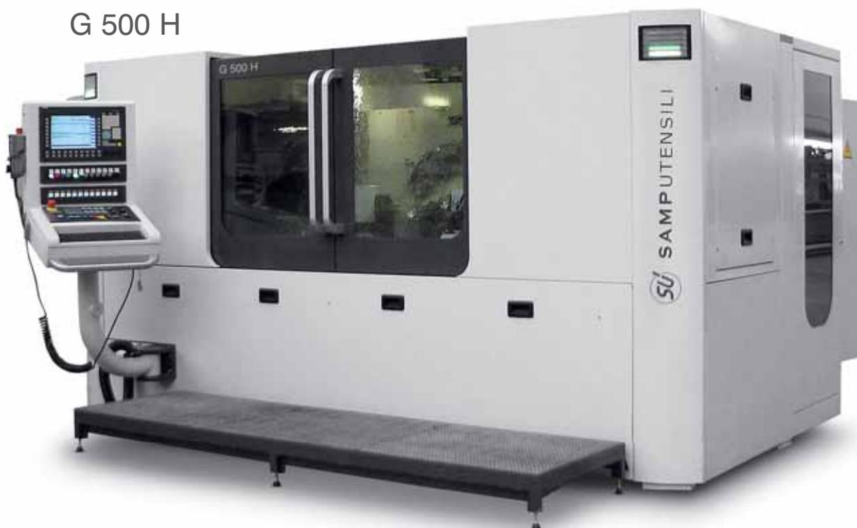
La G 500 H è la versione universale e flessibile della serie G. Adatta alla rettifica con passata singola di potenza di pezzi con dentatura esterna diritta o elicoidale, corone, alberi, filetti, rotori e viti in genere con diametro massimo di 500 mm.
